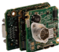
外置式影像擷取卡 OEM板, 用於CameraLink的Base和Medium模式攝影機
