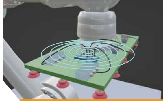
多個感測器 (例如振動、接近) 和執行器無線連接在手臂末端
