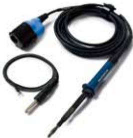
這相當于現有的BNC無源示波器探頭和HKTA197 10:1衰減器組合在一起。10:1示波器探頭具有固定的x10衰減，既適用于CAN和FlexRay等高速信號，也適用于更高的電壓信號（如初級點火）。
