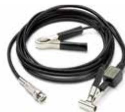
MI074是一種電容式的拾取器，連接在點火電路部件的絕緣層(如點火高壓綫)周圍，避免了直接連接高電壓。MI074與高壓點火延長綫匹配使用，可以同時檢測多個COP點火信號。
