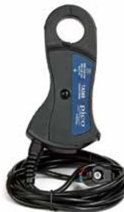
HKTA388的規格參數跟我們受歡迎的TA167 200A/2000A電流鉗一樣，但它配備了PicoBNC+接頭。當連接到Pico示波器時，PicoScope軟件自動配置電流鉗。量程切換是自動進行的，不需要用戶設置。電流鉗通過示波器供電，因此不需要任何電池。此外，當電流鉗連接示波器時，它會被自動歸零。
