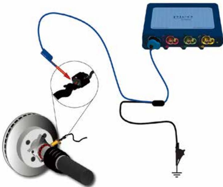
PicoScope軟件設置了通道A，你也可以連接其它通道到其它傳感器上，比較它們的波形。
