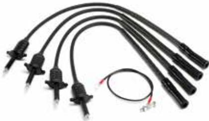
這套延長線特別適用於多個COP點火綫圈。簡單地把每根延長線安裝在每個綫圈和火花塞之間，然後把MI074次級點火拾取綫夾在每根延長線上。示波器將會顯示準確的點火波形和正確的千伏電壓值。
