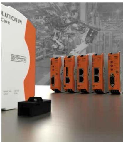
RevPi Gates 適用於所有常見的工業網絡協議，有助於將 Revolution Pi 集成到工業網絡中
