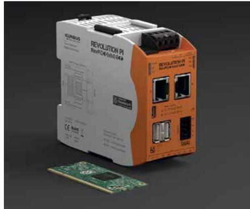
45mm，RevPi Connect 寬度是 RevPi Core 3 的兩倍
