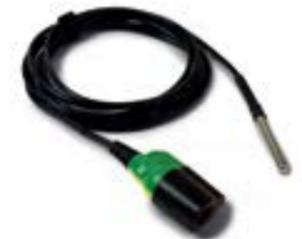
這溫度探頭是線性的溫度測試線，測量範圍為-40° C至125° C，適用於所有普通汽車和非公路用車。溫度傳感器封閉在一個5mm的不銹鋼外殼中，以提供接觸和氣流測量。
