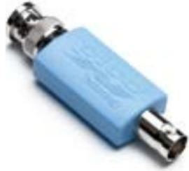
具有高帶寬和故障保護，10:1衰減器被設計用來測量噴油器和初級點火波形。
