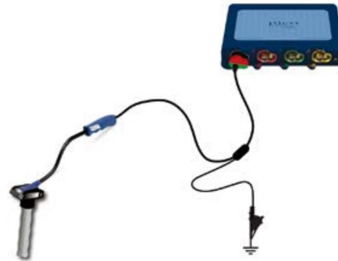
1. 將COP點火信號探頭連接到Pico示波器的通道A上，并確保它在發動機機體上有良好的接地。
