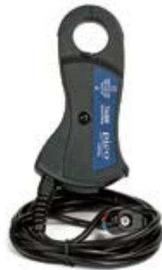
TA388的規格參數跟我們受歡迎的TA167 200A/2000A電流鉗一樣，但它配備了PicoBNC+接頭。當連接到Pico示波器時，PicoScope軟體自動配置電流鉗。量程切換是自動進行的，不需要用戶設置。電流鉗通過示波器供電，因此不需要任何電池。此外，當電流鉗連接示波器時，它會被自動歸零。
