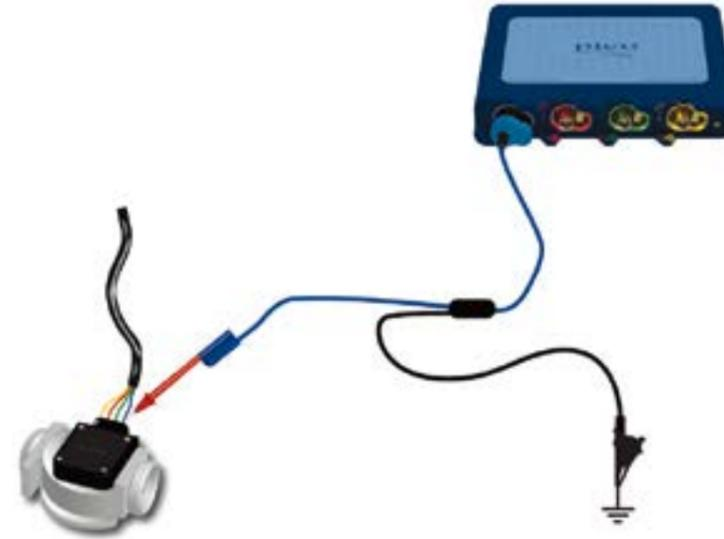
1. 利用車輛的數據資料找到傳感器信號線，並將Pico示波器的通道A連接到傳感器的信號線上。
