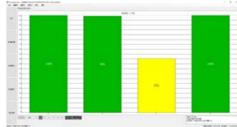
備注：PicoDiagnostics軟體支持兩種不同類型的壓縮測試：相對壓縮和絕對壓縮。但是，必須使用WPS500X壓力傳感器才能執行絕對壓縮測試。
