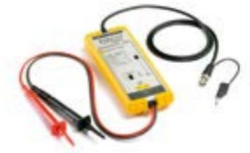
添加我們的1400V差分探頭到任何套裝，它可以測量更高的電壓，特別適用於混合動力和電動汽車。這個探頭的帶寬為25MHz，差分電壓範圍為1400V，CAT III等級。
