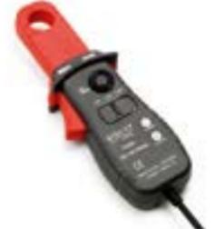
Pico電流鉗是我們起步套裝的重要添加附件，用于部件和系統的電流測量。
