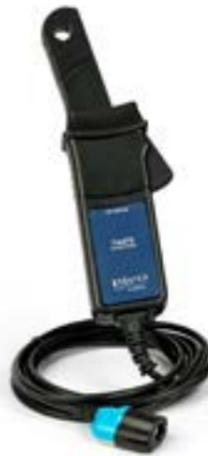
TA473是配備PicoBNC+接頭的60A電流鉗。當連接到Pico示波器時，PicoScope軟體自動配置電流鉗。量程切換是自動進行的，不需要用戶設置。電流鉗通過示波器供電，因此不需要任何電池。此外，當電流鉗連接示波器時，它會被自動歸零。這是一個非常緊湊的電流鉗，它可以連接到其它電流鉗可能無法進入的地方。
