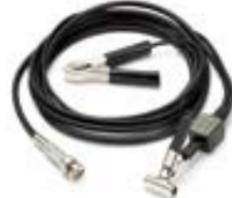
MI074是一種電容式的拾取器，連接在點火電路部件的絕緣層(如點火高壓線)周圍，避免了直接連接高電壓。MI074與高壓點火延長線匹配使用，可以同時檢測多個COP點火信號。
