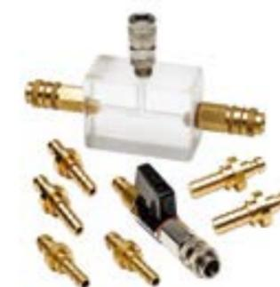
配備了這個套裝，你的壓力傳感器就可以進行低壓油管的測試。這個套裝包括1個可視方塊、1個用于測試燃油泵負壓的截止閥，以及3對連接不同尺寸燃油管的適配器。
