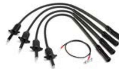
這套延長線特別適用於多個COP點火線圈。簡單地把每根延長線安裝在每個線圈和火花塞之間，然後把MI074次級點火拾取線夾在每根延長線上。示波器將會顯示準確的點火波形和正確的千伏電壓值。
