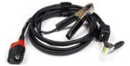
由于次級點火系統涉及高壓，因此我們無法通過直接連接進行測量。嘗試直接連接，幾乎肯定會損壞測量儀器。
