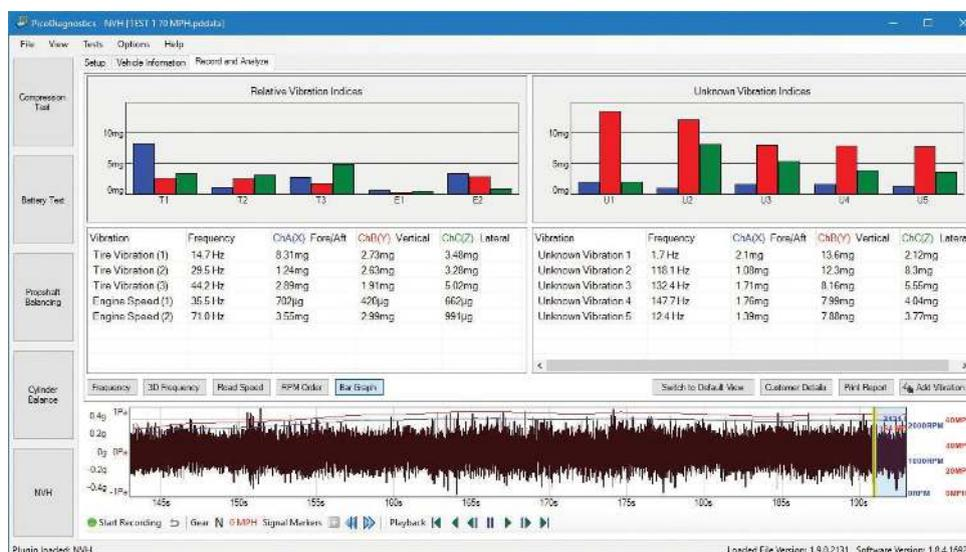
當你更加精通**PicoDiagnostics**軟體時，如果需要，你可以增加額外的振動階次。**E(Engine)**，即發動機)、**T(Tire)**，即輪胎)和**P(Propshaft)**，即傳動軸)指的是軟件正在分析的旋轉部件，並且在每種情況下，都有一個數字後綴。這個數字指的是每個記錄事件的振動階次(該部件每旋轉一周其振動所發生的次數)。下面這張圖顯示一個輪胎存在徑向跳動，每旋轉一周會產生一次振動。這叫做第一階次輪胎震動，或者在軟件上顯示為**T1**。
