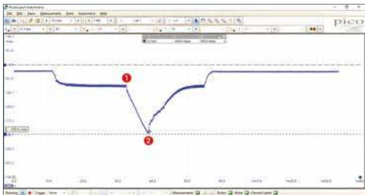
通过PicoScope和WPS500X，你可以验证低压燃油系统的完整性。我们可以看到基础压力、与油箱内的基础油泵相关的低压、燃油过滤器堵塞、油管或喷油嘴泄漏、以及燃油系统内的充气。
