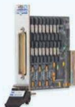
双16通道 汽车开关模拟器 (40-485)
